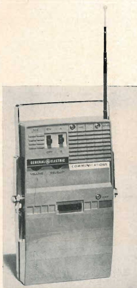
Un nuovo apparecchio radio ricetrasmittente portatile a transistor è descritto come il più piccolo apparecchio del genere disponibile oggi sul mercato. Denominato «Voice Commander» l'apparecchio ad altissima frequenza con modulazione di frequenza racchiude in un unico contenitore di plastica, ricevitore e trasmettitore. È destinato all'impiego da parte dell'industria, della polizia, dei pompieri ed ovunque si senta la necessità di disporre di un dispositivo di telecomunicazione che pesi poco e possa essere trasportato ed adoperato da singoli individui.
