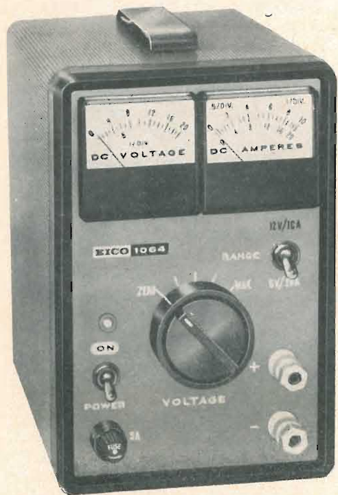
Un alimentatore di tensioni continue, con bassa ondulazione, di cui è possibile anche l'impiego quale dispositivo di carica per batterie, viene costruito dalla Eico. E' fornito per le tensioni 0...8V, 10A servizio continuo, e 0...16V, 6A servizio continuo, in scatola di montaggio o già cablato.
