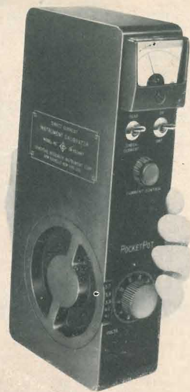
Sul mercato americano è comparso recentemente questo potenziometro c.c., miniaturizzato, con accuratezza dello 0,05%, destinato a misure di precisione. Ulteriori prestazioni possono essere ottenute con l'impiego di accessori. Per informazioni rivolgersi alla AURIEMA, EUROPE S.A., Bruxelles, Belgio.
